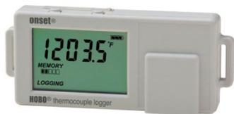
ホボ サーモカップルデータロガー(1チャンネル)は、J, K, T, E, R, S, B, N タイプのサーモカップルセンサー (別売) を接続することにより、屋内の温度を記録します。HOBOWare を用いて、ある特定の温度値にアラームを設定することができます。設定したある一定の条件になると、それまでとは異なる記録間隔でデータを記録するロギングバーストという機能もあります。統計モードでは、記録データの最小値、最大値、平均値、標準偏差を計算することができます。現在温度、ロギング状態、バッテリーの使用状況、メモリーの消費量を表示できる LCD 画面が組み込まれており、コンパクトな設計になっています。
