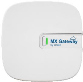
HOBO MX Gateway(以下、MX ゲートウェイ)は、MX シリーズデータロガーの計測データをウェブ上の HOBOLink®に自動的にアップロードします。設定は、スマートフォンやタブレットにインストールしたアプリ HOBOLinkconnect®(無償ダウンロード)で簡単に行えます。MX ゲートウェイは、設定後、Bluetooth(BLE)通信にて、通信範囲内にある MX シリーズデータロガー(100 台まで)のデータを定期的にチェックします。そして、データは WiFi やイーサネットを通じて MX ゲートウェイから HOBOLink に自動的にアップロードされ、データの email 自動送信やアラーム設定をしたり、データを画面(ダッシュボード)に表示したり、ダウンロードして詳細に分析をしたりすることが可能です。
