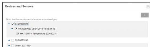
計測データの左側にある + をクリックして展開すると、計測センサー名、計測項目、シリアル番号などが表示されます。エクスポートしたいセンサー項目にチェックを入れます。
