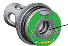
水に浸したフォームスワブで内側の O リングを清掃した後、フォームスワブで少量のシリコングリースを内側の O リングに塗布。
